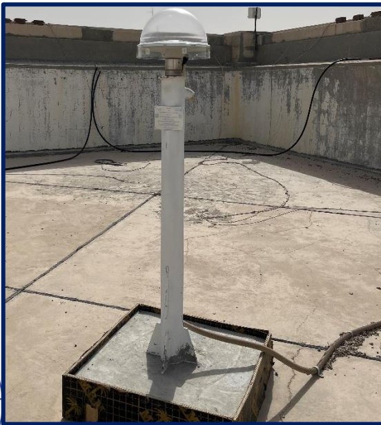
شكل (١) يوضح نوع الهوائي وموضع التركيب أعلى المبنى
